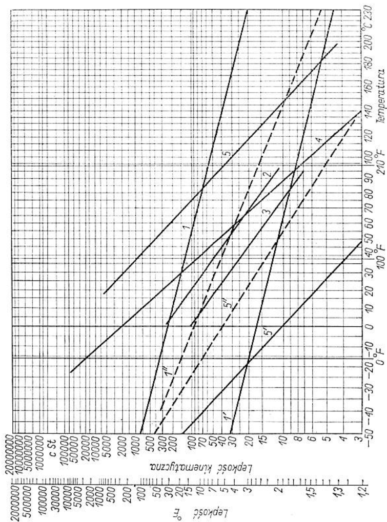
Rys. 1.7. Typowe zależności lepkości od temperatury cieczy roboczych o różnym składzie chemicznym; 1, 1' — górny i dolny zakres dla oleju silikonowego, 1'' — olej silikonowy DC 200/50, 2 — mieszanina poliglikolu i wody, 3 — emulsja wody w oleju, 4 — chlorowane estry fosforowe, 5, 5' — górny i dolny zakres dla oleju mineralnego, 5'' — olej mineralny OM15
